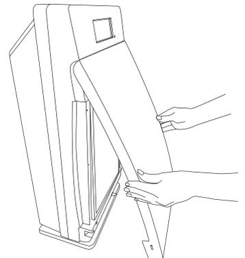
7 フロントパネル上部のつめを本体のくぼみに合わせ、ゆっくり押し下げる。フロントパネル下部をカチッと音がするまで押し込む。
