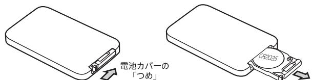
② 新しい電池をセットして電池カバーを戻します。
